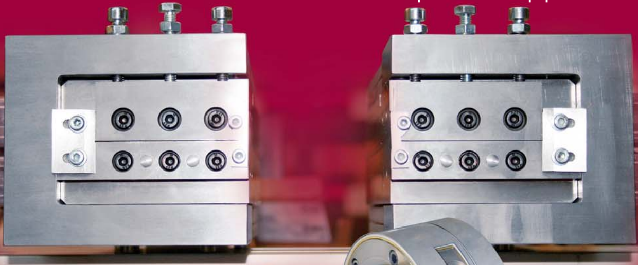
Doppelschlitzdüse für Klebebänder aus SEBS Double-slot die for SEBS adhesive tape manufacturing
